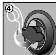
Entfernen Sie die Pumpe vollständig und schließen Sie den externen Stopper. Das Ventil sollte nun in sich selbst eingedrückt sein.
