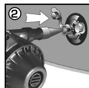
Befestigen Sie die Düse am Aufpumpstück der Pumpe. Stecken Sie die Düse an und schalten Sie die Pumpe ein.
