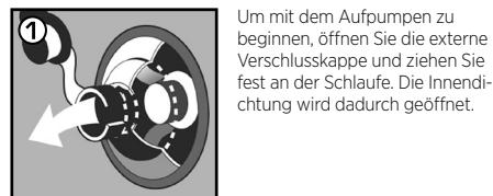
Um mit dem Aufpumpen zu beginnen, öffnen Sie die externe Verschlusskappe und ziehen Sie fest an der Schlaufe. Die Innendichtung wird dadurch geöffnet.
