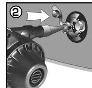
Sæt mundstykket på pumpens oppustningsende. Før mundstykket ind i ventilen, og start pumpen.
